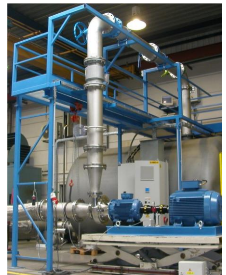
Abbildung 1. Prüfstand mit Rohrleitungen in DN 300 und 110 kW Frequenzumformer, für Pumpen mit einer Förderleistung bis 1000 m 3 /h.
