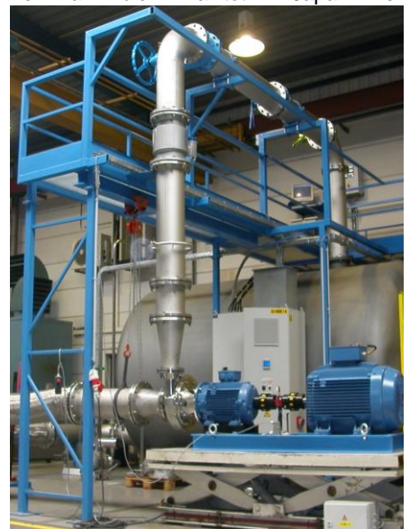
Afbeelding 1. Proefstand met leidingen van diameter 300 mm, frequentieomvormer van 110 kW,
